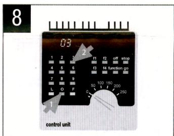
**1** Introduzca el enchufe del transformador a la red o apriete simultáneamente la tecla "stop" y "go" del Control Unit hasta que aparezca la cifra "99" en la pantalla (hacer un reset). Apriete la tecla "stop", de manera que el voltaje de la vía queda desconectado.
